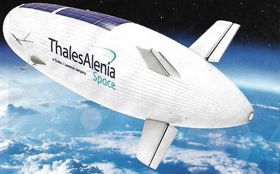
Projet Stratobus de Thales Alenia Space. Pour ce dirigeable de surveillance et de télécoms, le CEA a développé un nouveau type de cellules photovoltaïques, flexibles, ultralégères et peu coûteuses.
