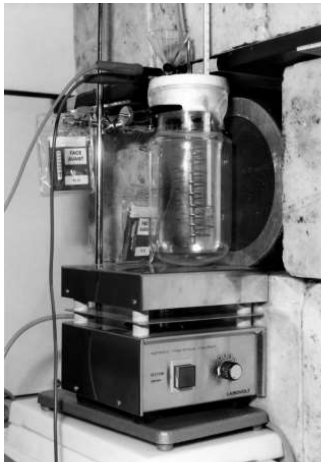
La cellule d'électrolyse
